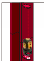
2つのレーザーターゲットを利用して鉄骨を垂直に設置可能！
