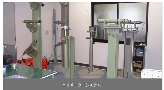
糸を張って検査する実測による検査ではなく、機械による（無限大コリメーター）精密な検査を実施しています。※レーザーレベル、レーザー墨出器など
